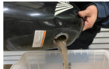
●漬け込み後タンクの溶液を排出（手順⑦）
