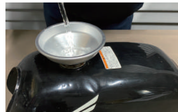
●サビタンキラー溶液注入～漬け込み（手順⑤）
